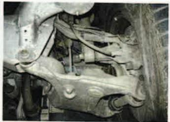
Pro BMW typickým problémem jsou vůle v horním příčném rameni zadní nápravy [s připnutou kabeláží] a po letech horší stav brzdových hadic
